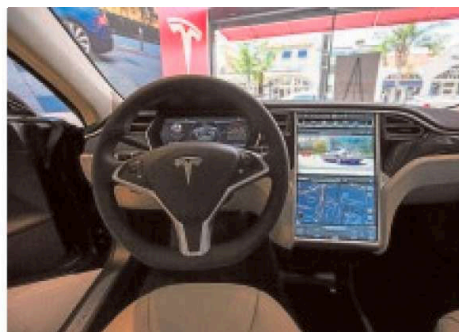
ORDENADOR A BORDO. Panel de control del Tesla 85D. Ocho cámaras ofrecen una visión de 360 grados alrededor del coche. El primer paso para un vehículo 100% autónomo
